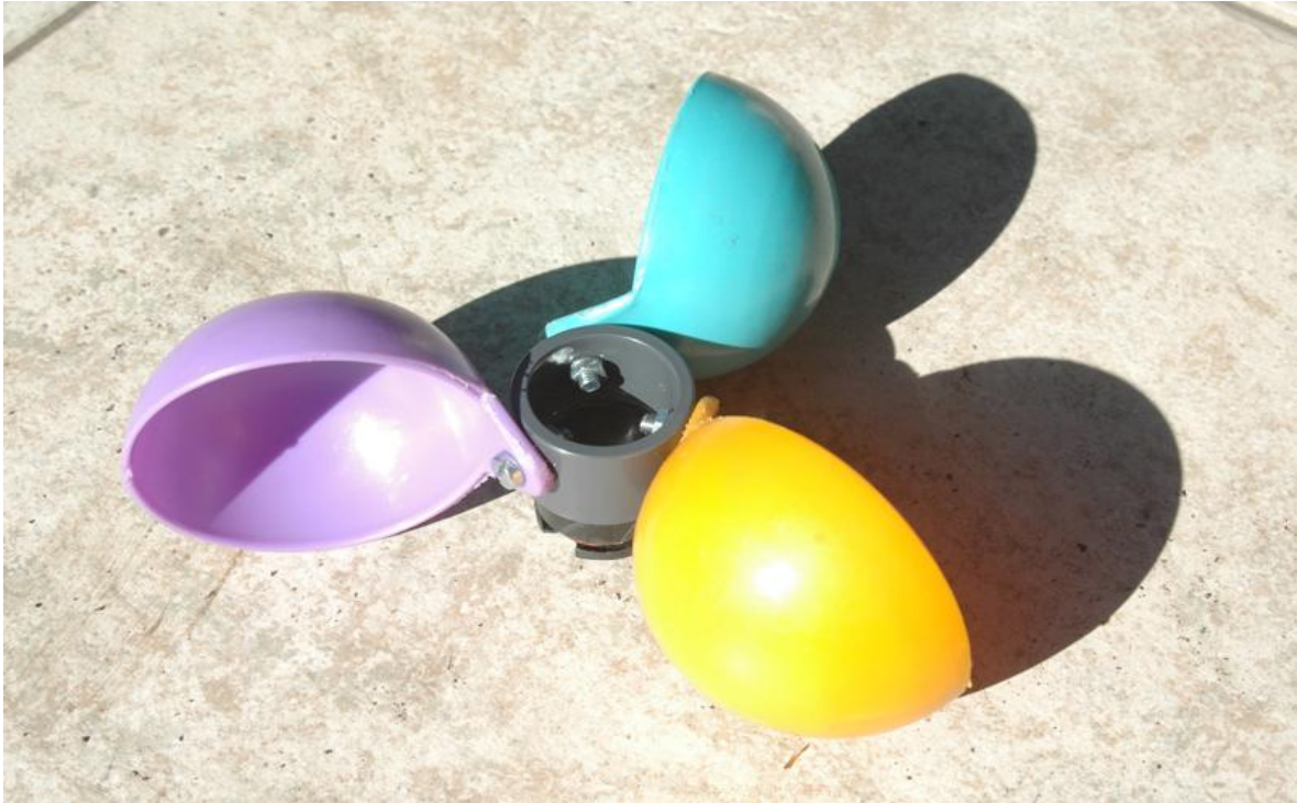
Figura 2. Copla ensamblada, con motor de fuente de poder como rotor.
