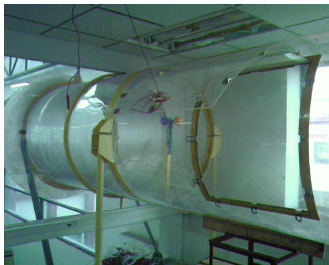
Figura 8. Vista lateral del anemómetro casero en el túnel de viento.
