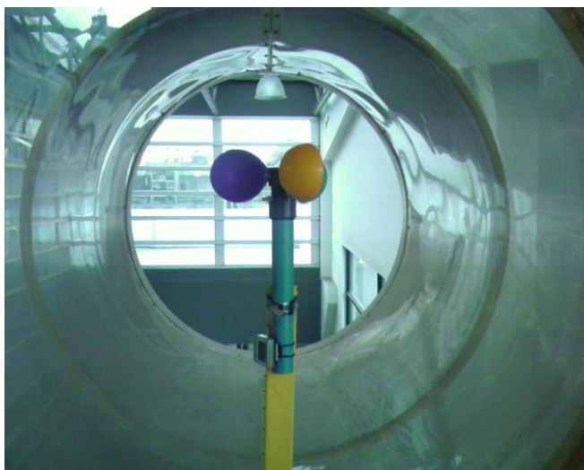
Figura 7. Vista frontal del anemómetro casero en el túnel de viento
