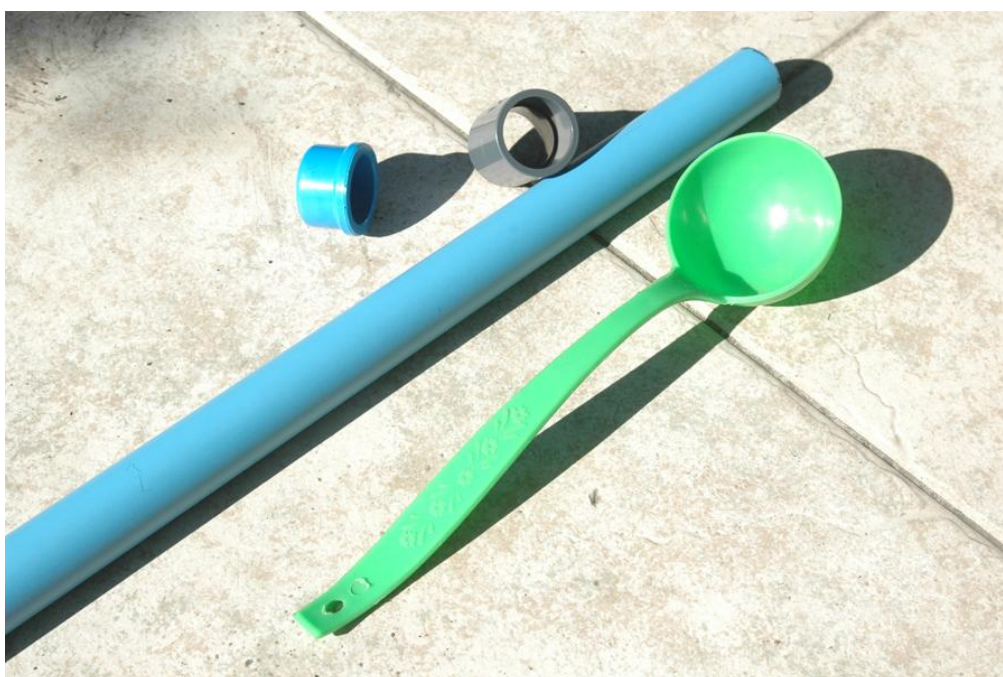
Figura 1. Pilar, tapagorro, copla y cucharón que fue transformado en copela
