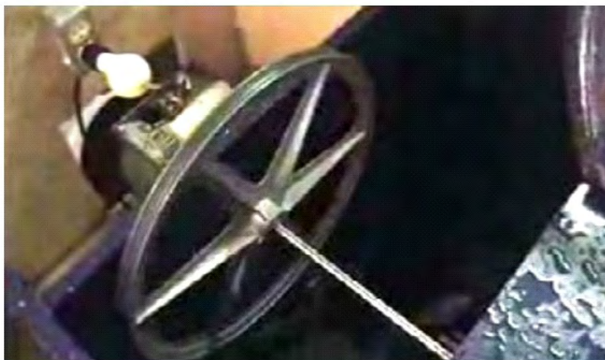
Generador que alimenta una bombilla normal
