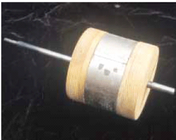
La armadura de madera sostiene ocho imanes neodmium-iron-boron arreglados con la polaridad alternadora alrededor esto es el perímetro
